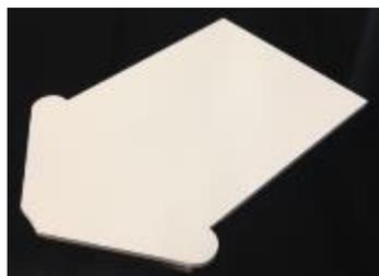
Die nachfolgenden Ergebnisse wurden im Rahmen des FFG Projektes HygO im Zeitraum von Oktober 2013 – September 2015 ermittelt. Die orientierende Untersuchung wurde auf Labormuster gegenüber definierten Wirkstofflösungen durchgeführt. Das Labormuster aus Acrylnitril-Butadien-Styrol (ABS) wurde auf Beständigkeit in einem Langzeitversuch getestet.
